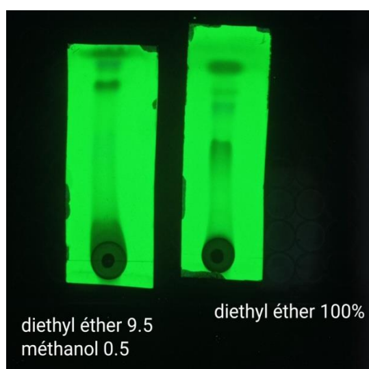
Figure 34: Révélation de la CCM sous lampe UV (254 nm).
